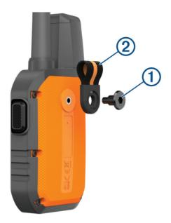
2 Fissare l'adattatore per il montaggio sul telaio ① alla parte posteriore del dispositivo mediante la vite lunga ② in dotazione.
